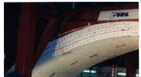
Ensayo del laboratorio del TRL: desde 20 toneladas hasta 45 toneladas.
