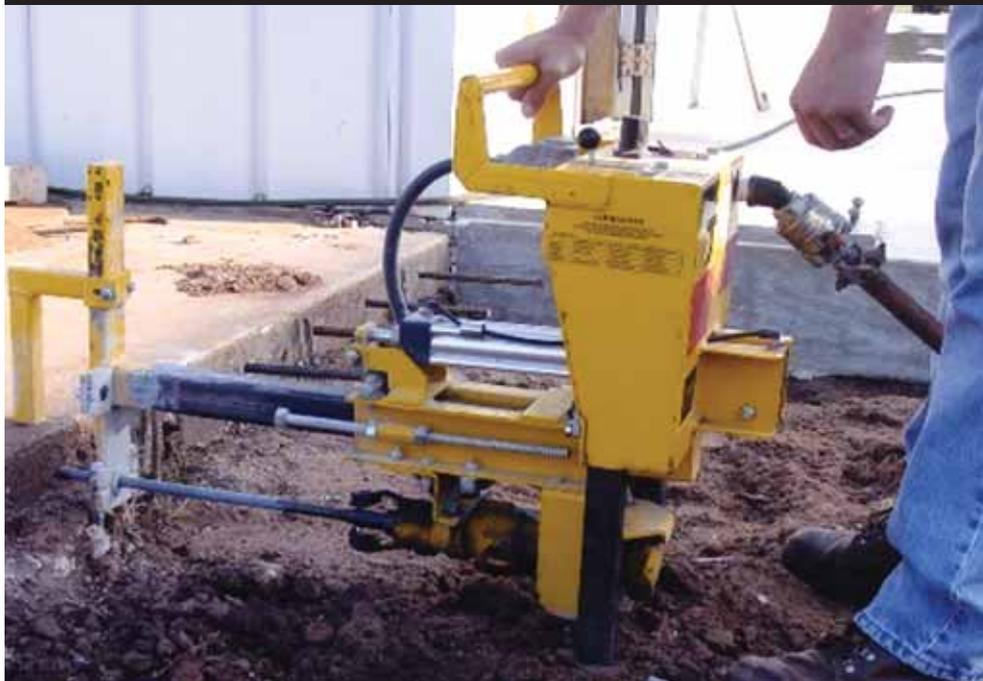
Este equipo de perforación neumático sobre terreno combina las ventajas de los modelos pequeños y una gran capacidad de perforación, superior a la que ofrecen otras herramientas manuales.
