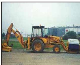
Equipo de perforación con compresor de aire
