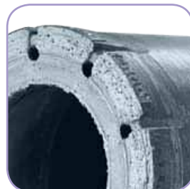
Usure complète et normale de la matrice Normal end of life
