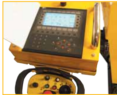
Panel de control y control remoto inalámbrico
